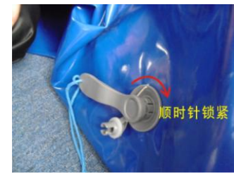
9. 气嘴把手的使用(如上图) 在发现气嘴边缘漏气时,用维修握把套入气嘴的槽内然后顺时针锁紧.最后旋紧盖子
